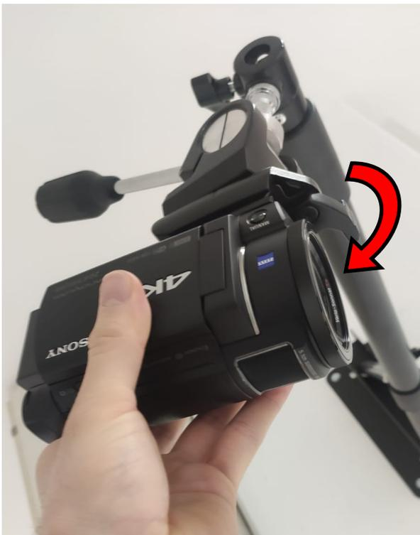
Kamera mitsamt Halterung befestigen durch kräftiges drücken des Hebels
